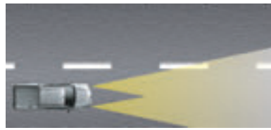
Luces de carretera
